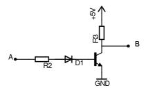
Liegt am Eingang eine Spannung von 0V an, dann fließt kein Basis-Emitter-Strom (da sie auf gleichem Potential liegen) und der Transistor sperrt. Sein Widerstand wird sehr viel größer als der von  $R_3$ , daher fällt an  $R_3$  nur wenig Spannung ab und am Ausgang liegen fast 5V an.
