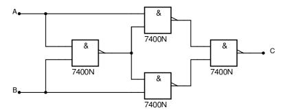
Der Vorteil besteht darin, dass man mit nur noch vier logischen Bauteilen auskommt.
