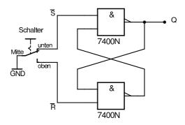
Hat der Schalter Kontakt, so wird im Flip-Flop eine 1 gespeichert, da dann S gesetzt ist. R ist in dem Fall 0, da offengelassene Eingänge als 1 gelten und  $\overline{R}$  somit 1 ist. Verliert er den Kontakt wieder, so sind beide Eingänge offen, also 1. S und R sind damit 0, und im Flip-Flop findet keine Änderung statt. Die nachfolgende Schaltung liest den vorher gespeicherten Wert aus dem Flip-Flop aus.
