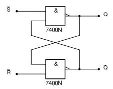
Liegt an S 1 an, so ist  $\overline{S}$  0. Damit ist das Ergebnis des NAND unabhängig vom zweiten Eingang 1, und somit ist Q 1. Liegt an R 1 an, so gilt das gleiche
